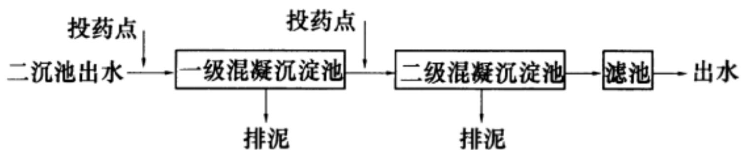
**2 化学除磷投加的絮凝剂品种及投加量**依据水中总磷、碱度等水质参数确定。常用的铁盐絮凝剂有硫酸亚铁、氯化硫酸铁和三氯化铁；常用铝盐絮凝剂有硫酸铝、氯化铝和聚合氯化铝。当采用石灰作为絮凝剂，宜采用铁盐作为助凝剂。当后续采用紫外消毒时，不宜选用铁盐絮凝剂。
