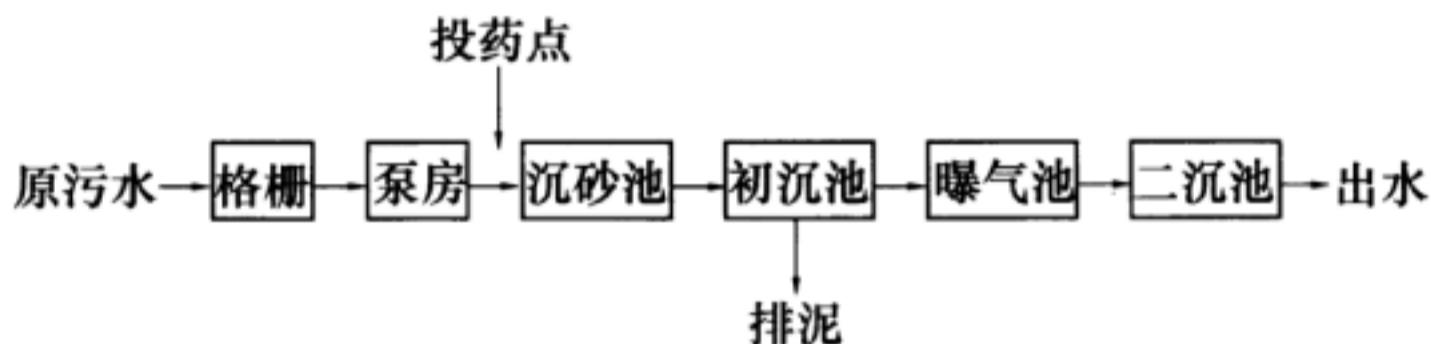
前置沉淀工艺适用于现有污水厂需增加除磷措施的改建工程。
